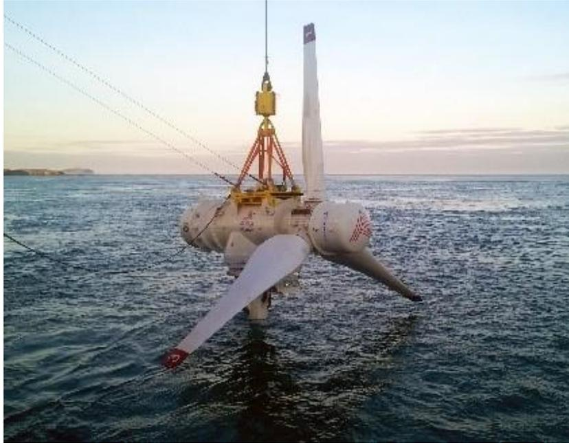
図16 アトランティス潮流発電装置 AR1500
