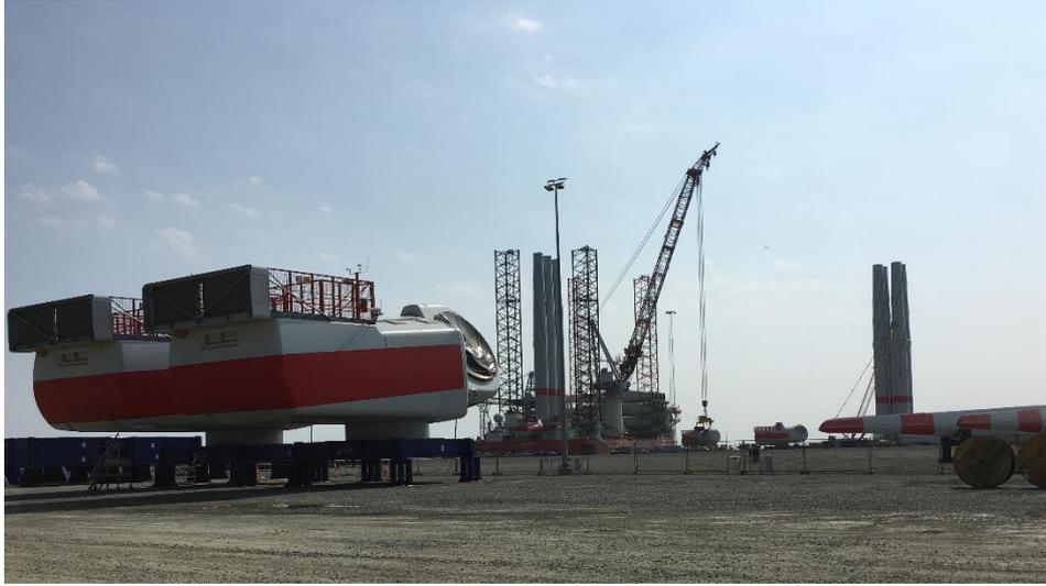
図 8 手前が洋上風車のナセル 奥が洋上風車の部品の積み込みの様子
