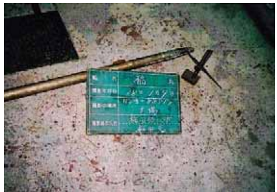
ごみの絡みつきにより破損したシャフト
