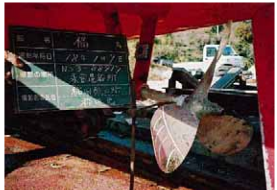
ごみの絡みつきにより破損したプロペラ
