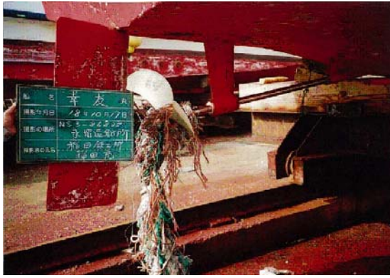
プロペラ部分への海洋ごみの絡みつき ごみの絡みつきにより破損したプロペラ 海岸に漂着した危険な漂着物の例
