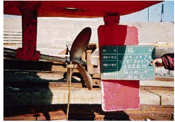
プロペラ部分への海洋ごみの絡みつき ごみの絡みつきにより破損したプロペラ 海岸に漂着した危険な漂着物の例
