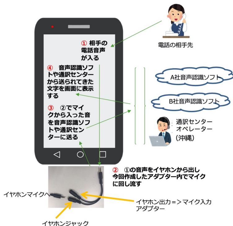
図表 4 文字付き電話の仕組み
