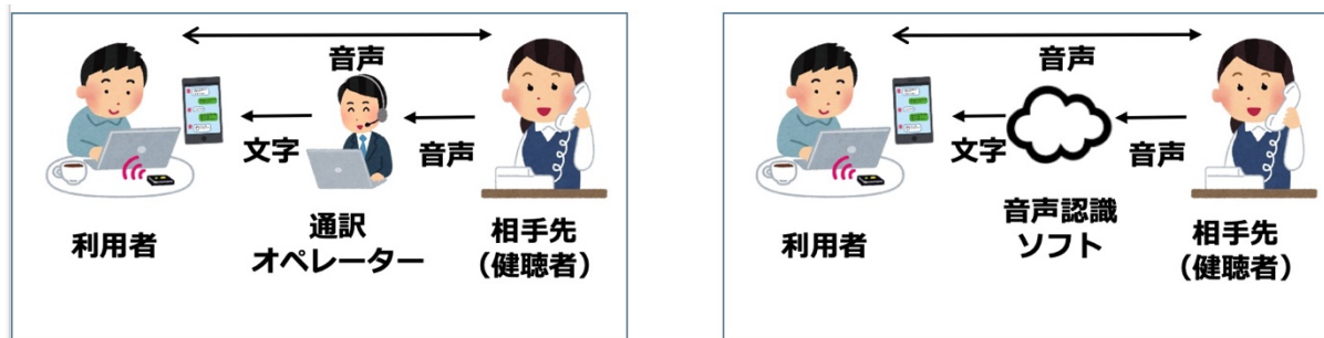
図表 6 文字付き電話のオペレーター入力と音声認識ソフト利用
