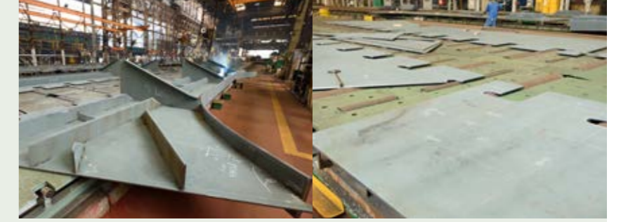
歪まないように鋼材を溶接する技 切り出された鉄板から組み立てが始まる
