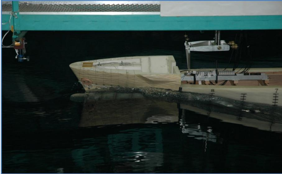
船舶が走行するとき水面は盛り上がり、波はこの盛り上がった水面の上を進みます。このとき、スプレー状の波が船体にかかり、抵抗となります。これを抑え、波浪中抵抗増加を低減させるために、船首部水面上に設置する付加物が、ステップです。
