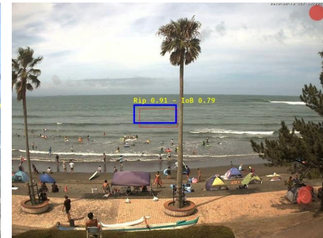
Fig.10 アノテーションエリアとAIの検知結果の例
