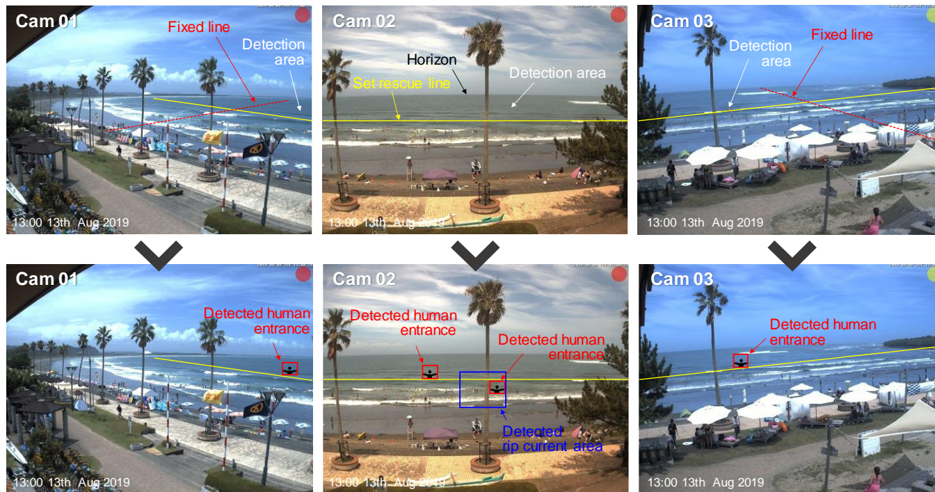
Fig.21 沖向きの強風発生時のアラートとレスキューシステムの検知条件
