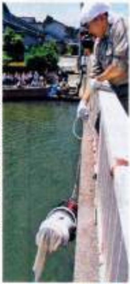
水中から引き揚げられるプラスチックごみの回収装置。いずれも金沢市大野町の大野川で
