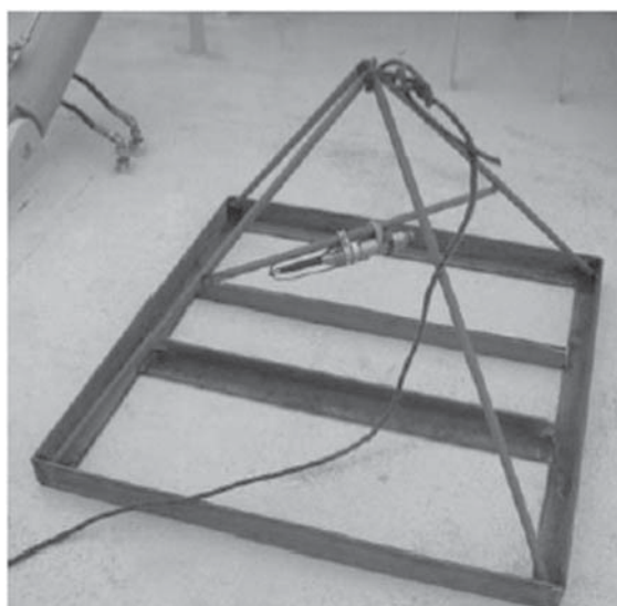
図 5 : 海底ケージに固定されたハイドロフォン
