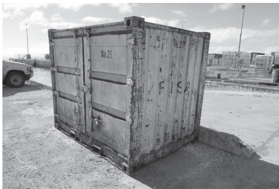
船と一緒に供与したコンテナと曲がった取っ手（ロック出来ない状態）
