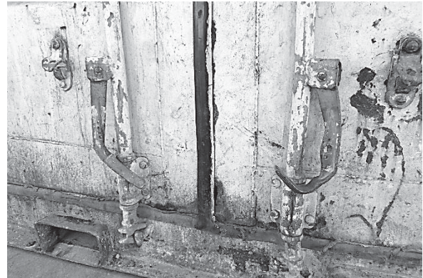
船と一緒に供与したコンテナと曲がった取っ手（ロック出来ない状態）
