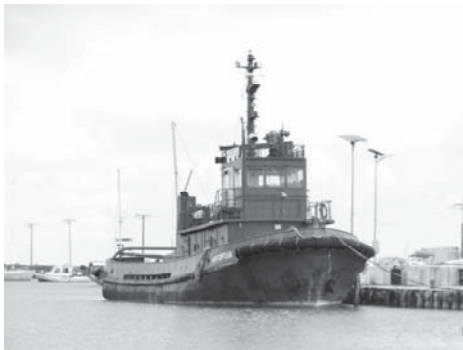
(PAT 所有の) 1994年日本無償供与のタグボート、船体外板の腐食が進んでいる
