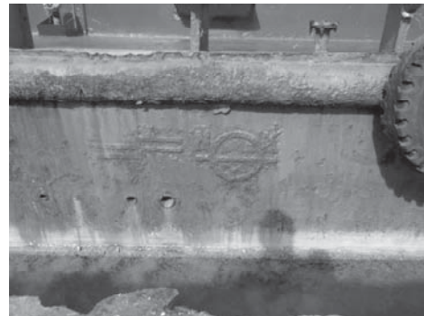
(PAT 所有の) 1994年日本無償供与のタグボート、船体外板の腐食が進んでいる
