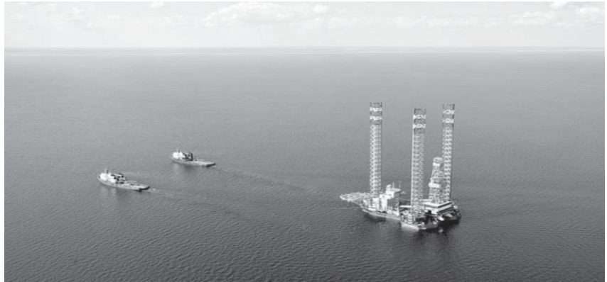
図 4 曳航移動中の自己昇降式掘削装置 Arkticheskaya [3]
