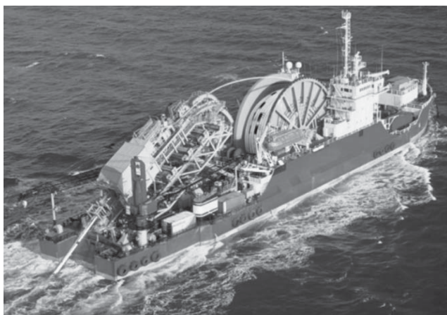
図 94 S-レイ工法用設定での垂直リール [40]
