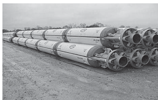
図 34 浮体モジュールが装着されたライザージョイント [18]
