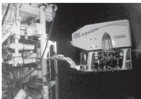
図 40 サブシーBOP スタックを操作中の ROV [23]
