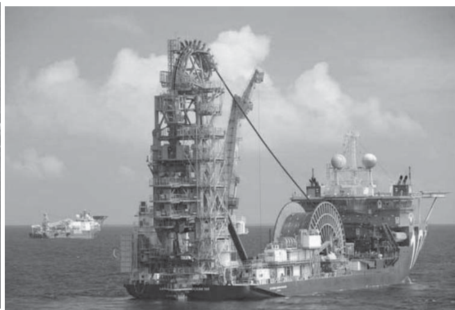
図 95 J-レイ工法用設定での垂直リール [41]
