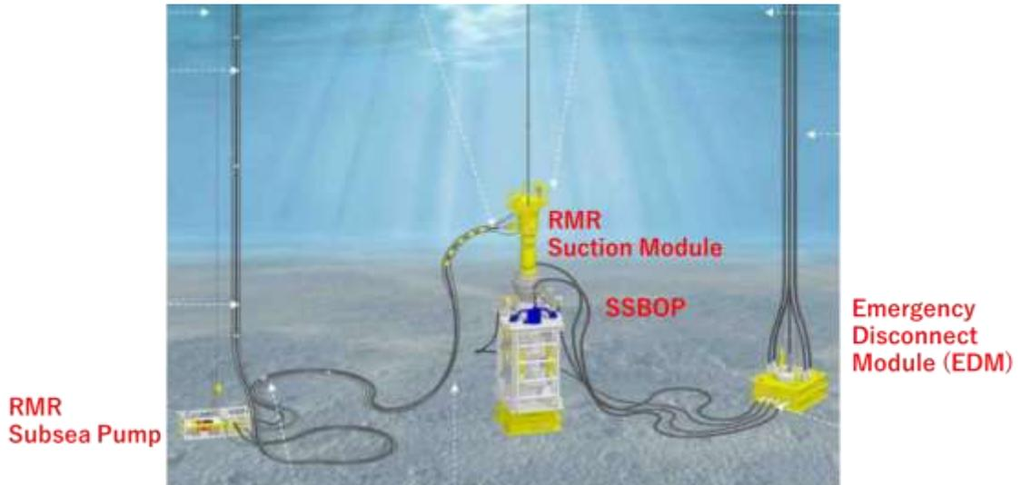
SSBOP と EDM の海底設置イメージ (RMR も使用するケース)
