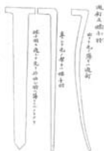
通釘(「大和形船製造寸法書」の頭釘の図)
