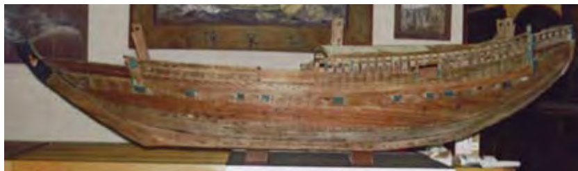
讃岐金刀比羅宮 かみら宮 に寛政8年(1796)に奉納された雛形 ひながた “金比羅丸” こんひらまる (金刀比羅宮蔵) 船首部のみに菱垣を付けた表菱垣廻船です。約710石積の1/10模型。実船換算で全長27.6m、航長13.9m、肩幅6.3m、 肩深2.2m。
