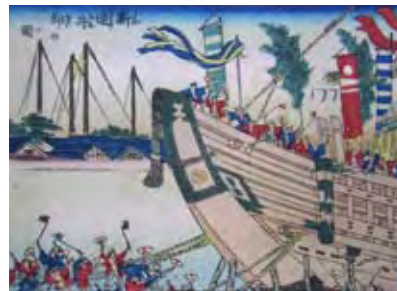
「大日本船路細見記」の新造船卸の図に描かれた弁才船の進水の様子。船を引き出すための、下貫木に結ばれた綱が描かれています。（船の科学館蔵）
