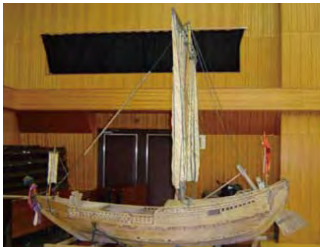
大江八幡宮 やまはた宮 (静岡県牧之原市)の祭礼用樽廻船雛形 ひながた (牧之原市相良史料館蔵) 製作は文政7年(1824)、約570石積の1/10模型。実船換算で全長24.3m、航長13.1m、 肩幅6.2m、肩深2.0m。航長/肩深=6.6でこの雛形には肩深を深くする樽廻船の傾向は見 られません。
