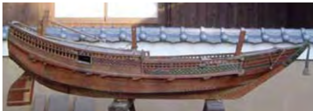
小浜金比羅神社（福井県小浜市）のご神体「金比羅丸」（小浜金比羅神社蔵） 船首部の垣立に菱垣模様があります。製作は文久3年（1863）、約310石積の1/10模型。実船換算で全長22.0m、航長10.9m、肩幅4.9m、肩深1.6m。
