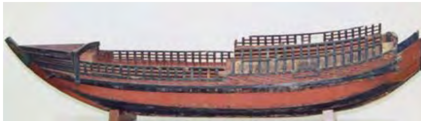
元禄5年(1692)に製作された現存する最も古い菱垣廻船の雛形(堺市博物館蔵) 370石積の1/10模型。実船換算で全長20.9m、航長12.1m、肩幅4.8m、肩深1.8m。
