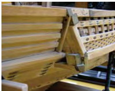
大江八幡宮の菱垣廻船雛形“八幡丸”の五尺と表垣立(牧之原市相良史料館蔵)
