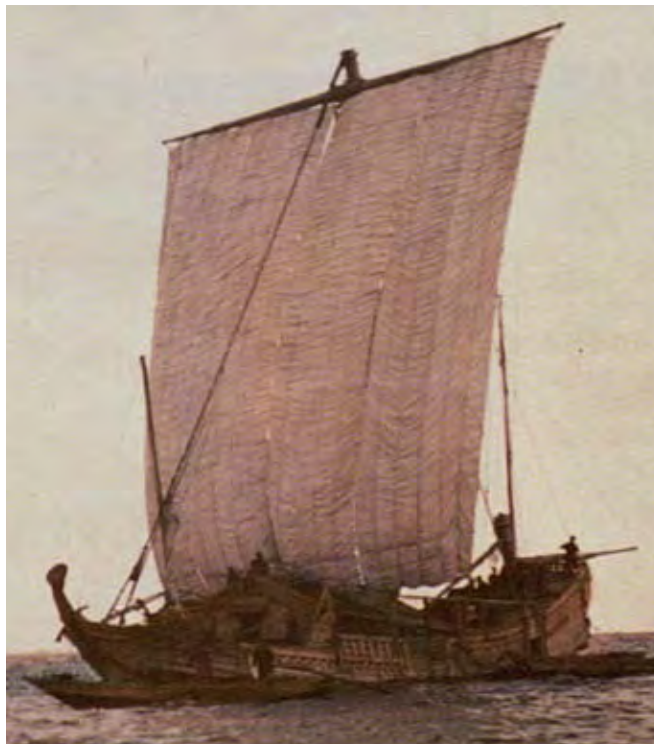
入港間近の22反帆、およそ800石積の弁才船。明治20年代の撮影とされています。帆の各反には細かいドレープ（たるみ）があり、縫下しに銭口で留められていることによるものと考えられます。（個人蔵）
