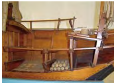
横隔壁の無い弁才船の船倉(鉄道博物館蔵の半割模型)
