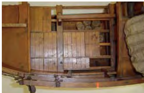
根太上に置かれた踏立板を一部取り外した弁才船の甲板。 左側は水密の合羽。(鉄道博物館蔵の半剖模型を上から撮影)
