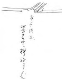
関船諸名集図解に示された「シャチ継ぎ」
