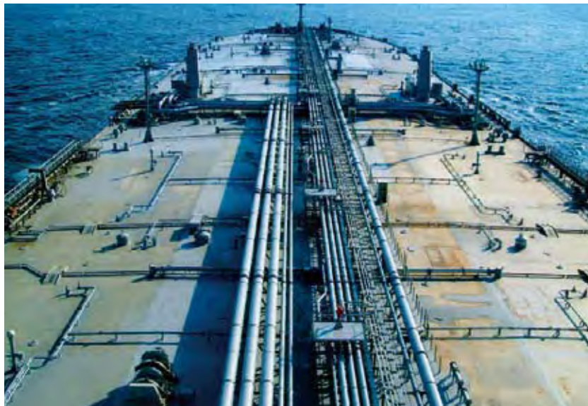
VLCCの船橋から見た上甲板の配管
