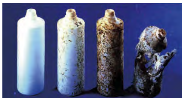
生分解性プラスチック製品の土壌での分解の様子
