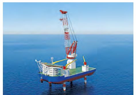
建造中のSEP型多目的起重機船 (出典：五洋建設(株))
