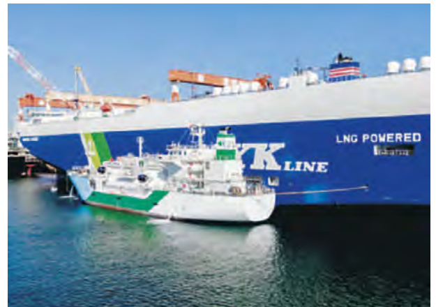
「かぐや」のLNGバンカリングの様子 (出典：セントラルLNGマリンフューエル(株))
