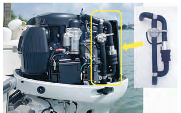
マイクロプラスチック回収装置を取り付けた船外機 (出典：スズキ(株))
