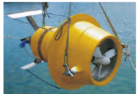
浮沈式潮流発電装置（出典：長崎大学）
