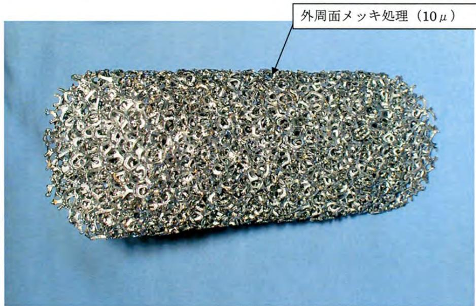
図 5 - 2 金属多孔質体外周面にメッキ処理
