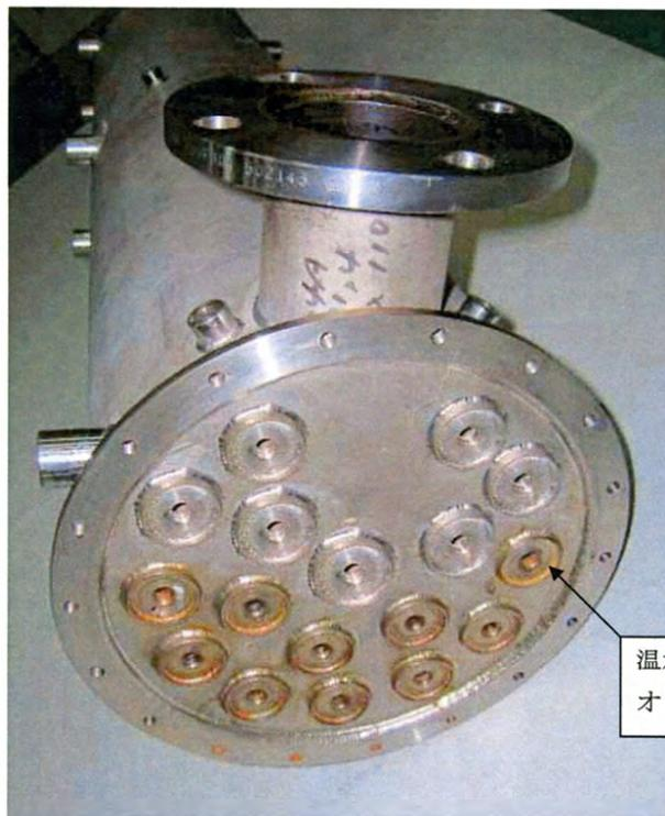
図5-8 排気ガス-水蒸気熱交換器の温水導入口
