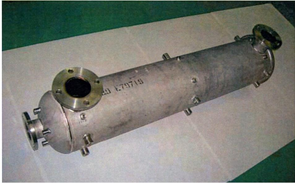
図5-7 排気ガス-水蒸気熱交換器の外観
