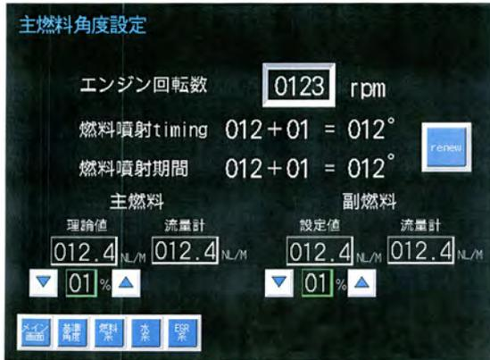
図 7-8 主燃料の噴射タイミングと噴射量設定
