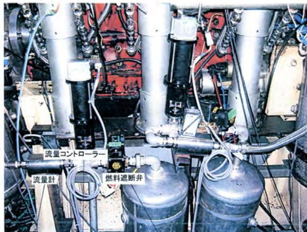
図 7-13 主室燃料制御装置
