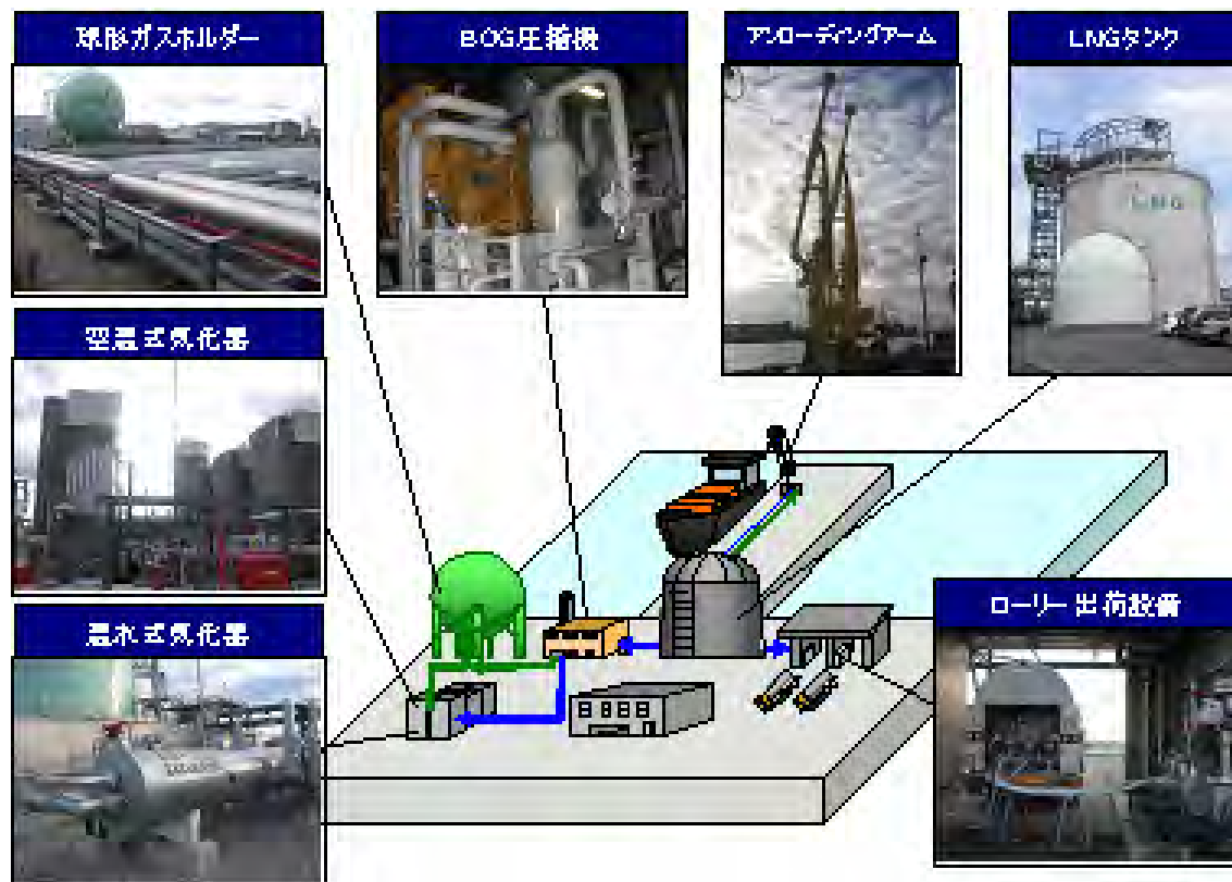
図 5-3 内航 LNG 船受入基地における陸上施設
