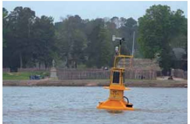
図2 31 チェサピーク湾に設置された海洋観測ブイ ( http://www.cbos.org/ )
