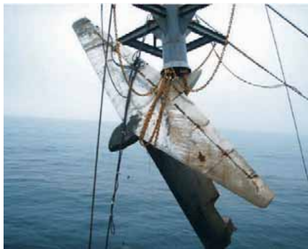
図2 25 網チェーン式回収装置（提供：（独）港湾空港技術研究所）
