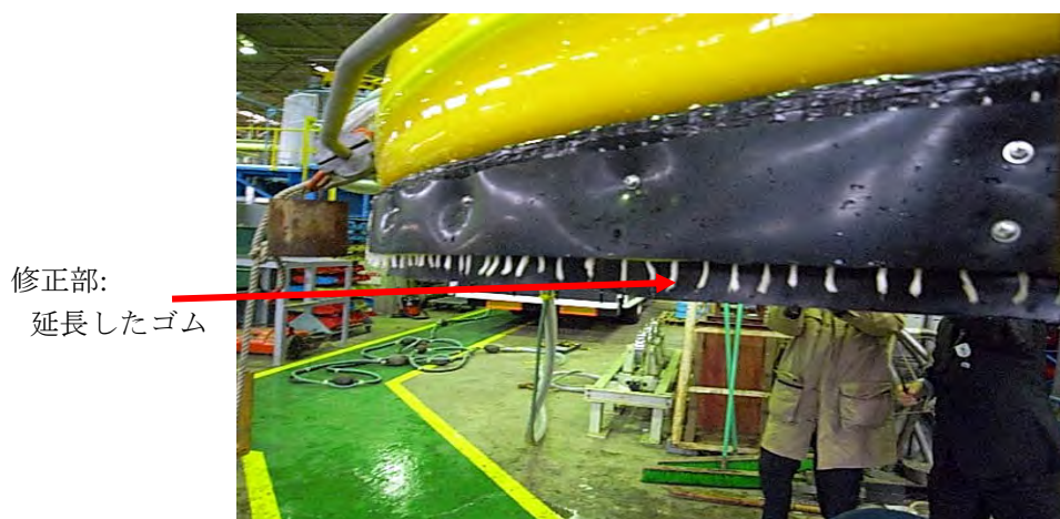
Figure 4.3-7 拡散防止ガードの修正
