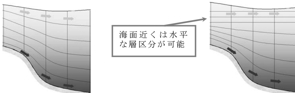
図 1.2.5 従来の \sigma 座標(左)と一般鉛直座標(右)による鉛直層分割の例
