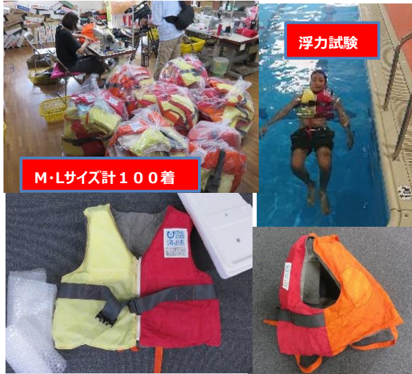
改良版ライフジャケットの製作、デザインも一新、着心地を考慮、浮力材として発泡アクション（左下）を活用
