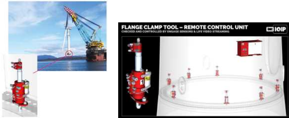
図 3.2 : Hywind Scotland プロジェクトで使用された FCT (出典 : IHCIQIP 社カタログ)
