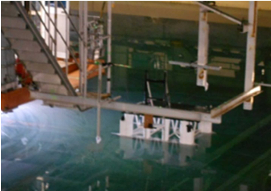
図 2.1 : セミサブ風車設置船水槽試験
