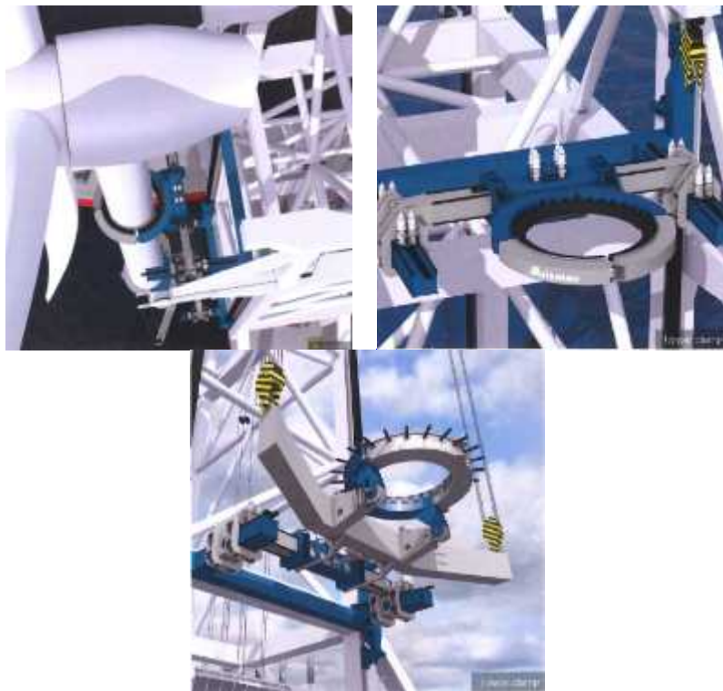
図 4.2 : 風車のタワーを掴む上下の Clamp (出典 : Huisman 社カタログ)
