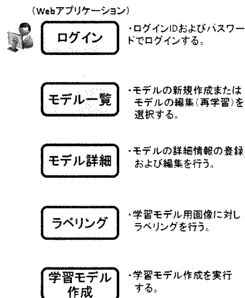
図 3. 2-5 欠陥検出画像認識 Web アプリケーションの流れ
