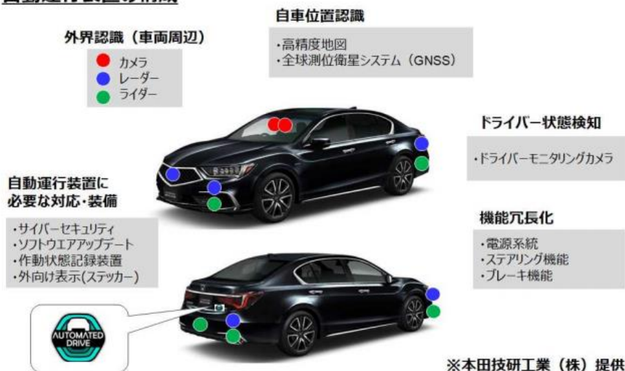
図 1.4.17 国土交通省自動車局プレス発表資料 (2020年11月11日付け) より 自動運転装置の構成 https://www.mlit.go.jp/report/press/content/001372477.pdf
