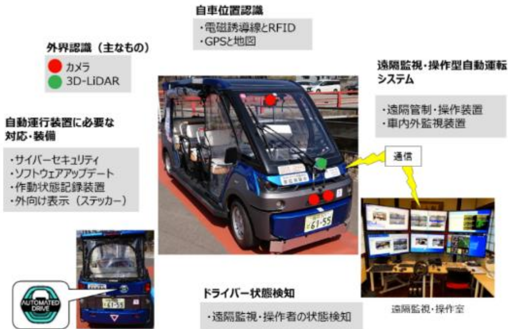
図 1.4.22 主な自動運転装置の構成
