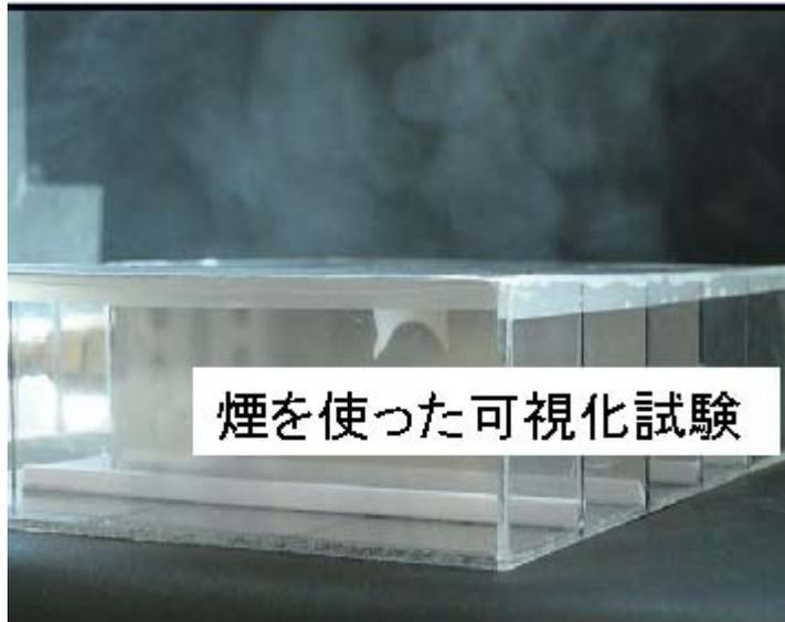
構造・強度、就航後メンテナンス、複数個の吹き出し口から出来るだけ同量の空気が吹き出す事を目的とした空気チャンバーの内部構造を検討した。
