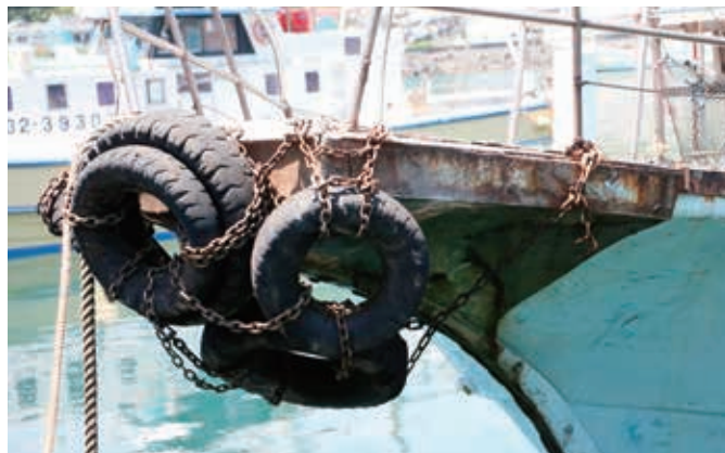
▲タイヤと鉄板で補強されている渡船の舳
