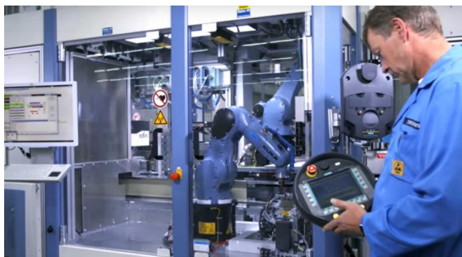
タブレット端末によるロボット工程管理（出所：Siemens）
