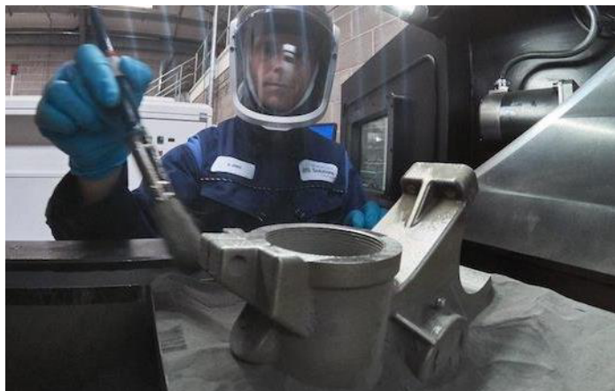
AM 製造で再現された Ruston Hornsby ステアリングボックス (出所：TCT Magazine)
