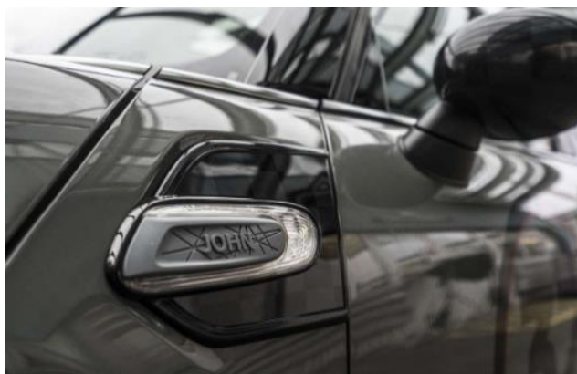
MINI の 3D 印刷製造された名前付きサイドインジケーター（出所：BMW）
