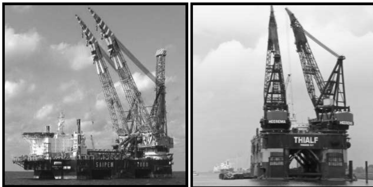
図 5-14 代表的な重量運搬船：セミサブ型クレーン船 （左：Saipem 社 Saipem7000、右 Heerema 社 Thialf）
