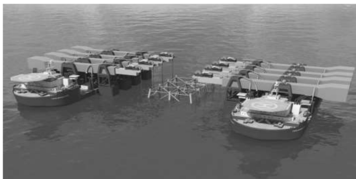
図 5-19 双胴船型吊り上げシステム (Seametric International Twin Marine Lifter)
