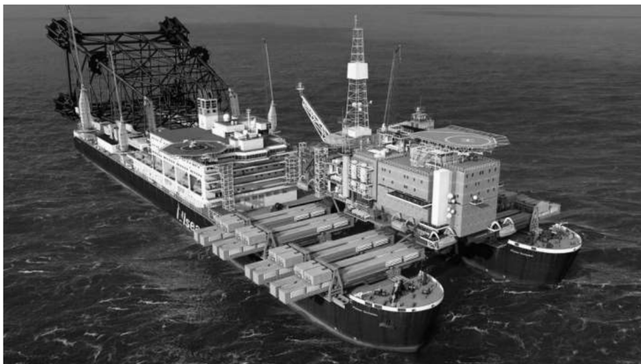
図 5-18 双胴タンカー船ジャケット・トップサイド吊り上げシステム (Allseas Pioneering Spirit Lifting System Topsides/Jacket)
