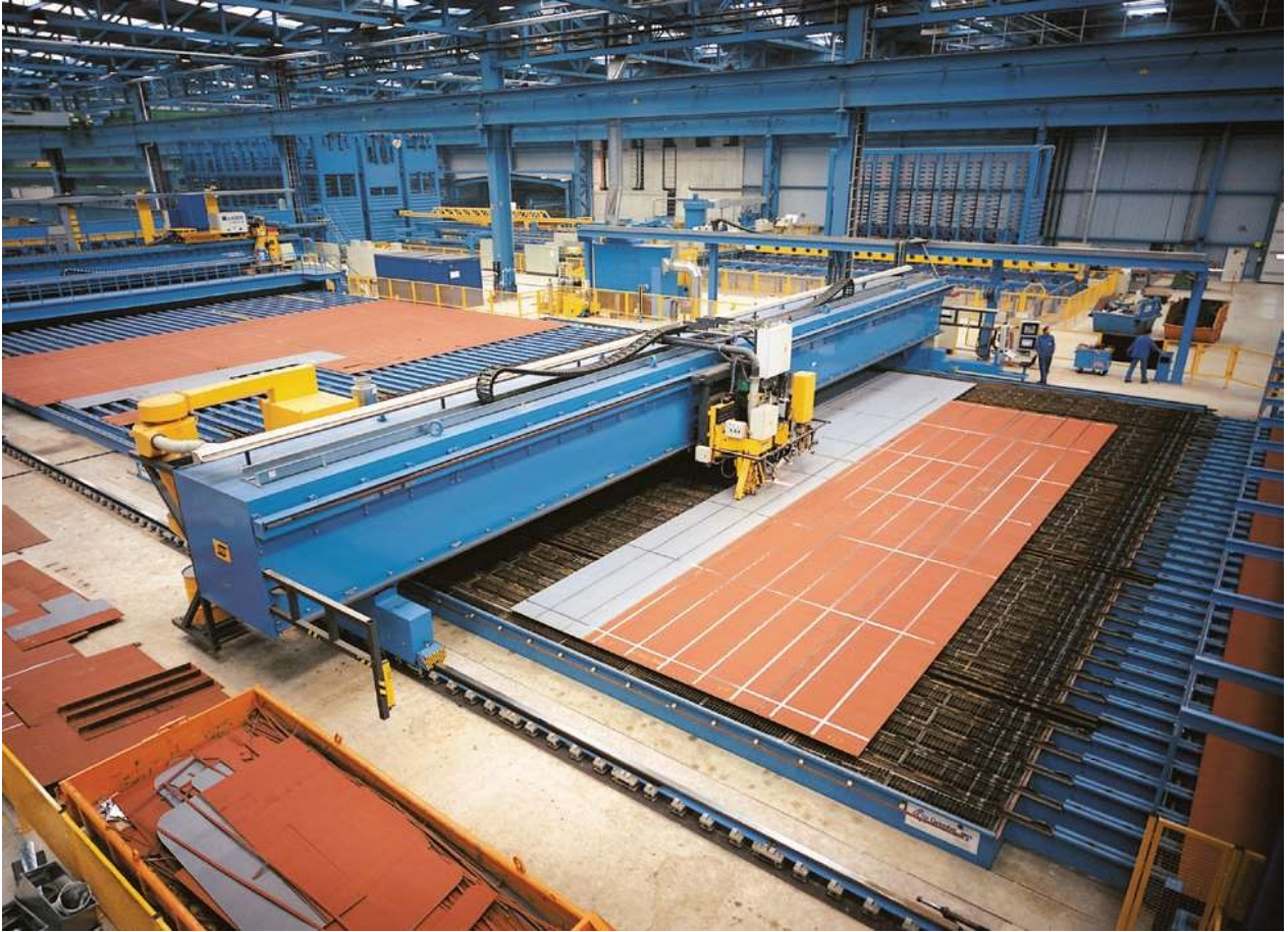
図 2-10 世界最大級のレーザー溶接設備：
