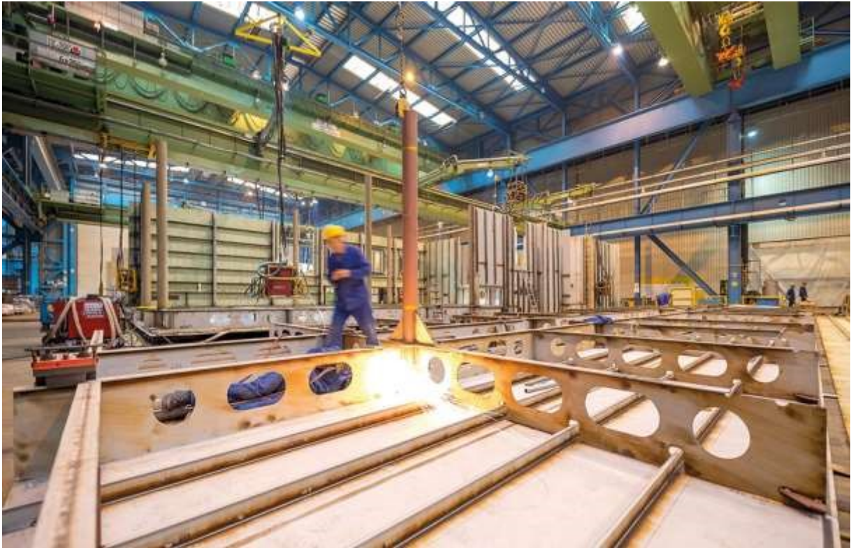
図 2-9 レーザー技術を利用した船体建造（ドイツ・パーペンブルク）
