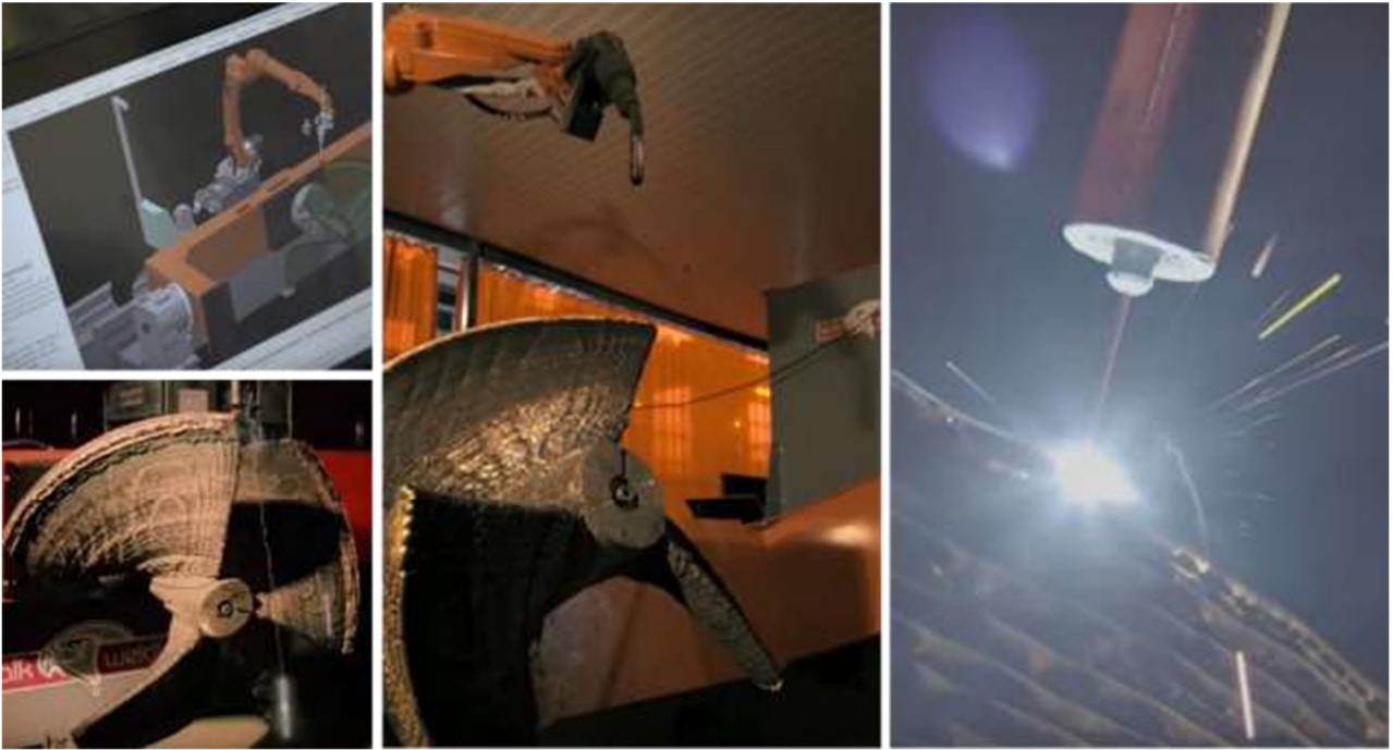
図 2-19 3D 印刷されたプロペラ（出所：Damen）
