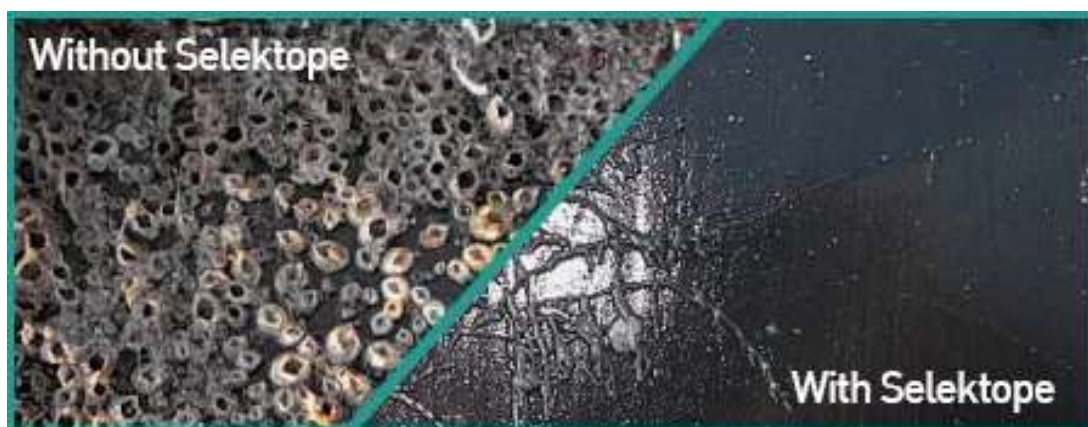
図 3-8 Selektope の船体防汚ソリューション「I-tech」(出所： www.selektope.com )
