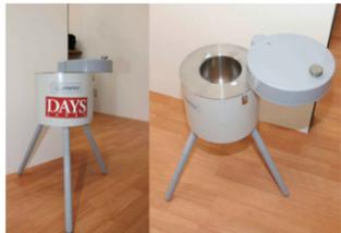
福島市の測定所では、食品の測定器(写真)3台と、ホールボディカウンター1台を備える。
