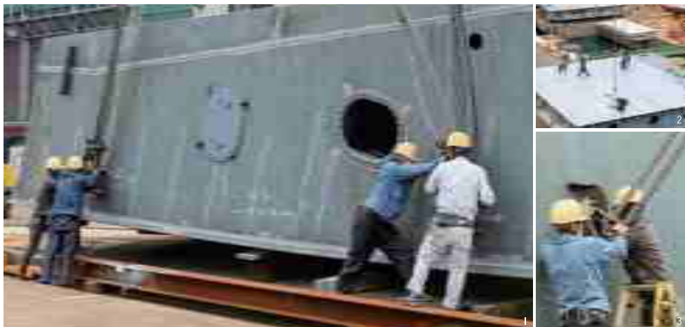
地上で製造されたブロックをクレーンで吊り上げ、下から積み上げながら船の形をつくっていく。そのブロックを1つずつ取り付け、つなぎ合わせるのが白杵工業の役目だ
