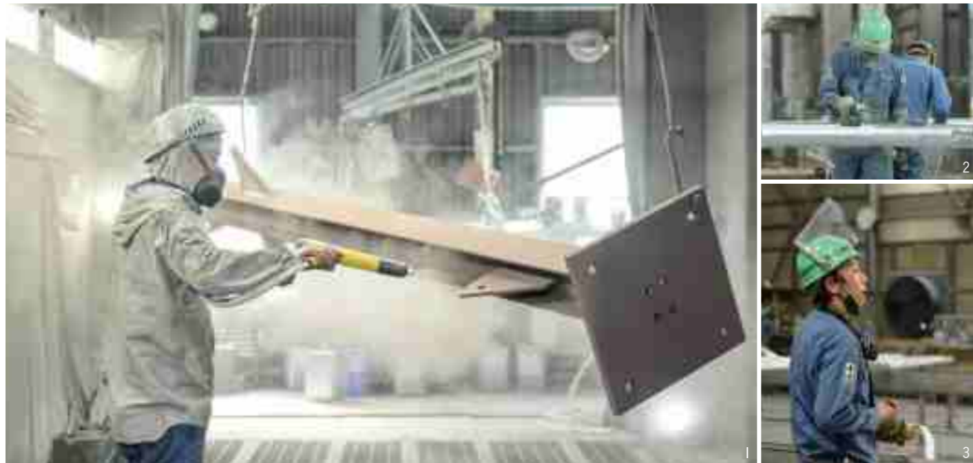
1.微細な粉を吹き付けながら、ムラなくきれいに塗装する。免許取得者がなせる熟練の手技だ 2.3.ムラや不純物が残っていないか、職人たちが目を光らせる。最後の仕上げ作業も大切な仕事
