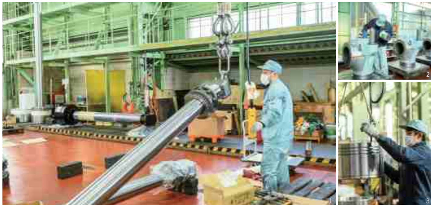
1.主力製品の1つである「ピストンロッド」は、長いもので4メートルくらいに達するそう。スケールの大きさは圧巻だ 2.3.このほかにも、「ローラーガイドケーシング」や「連接棒」「チェーン緊張装置」などの様々なパーツを製造しており、社員がそれぞれの持ち場で腕を振っている
