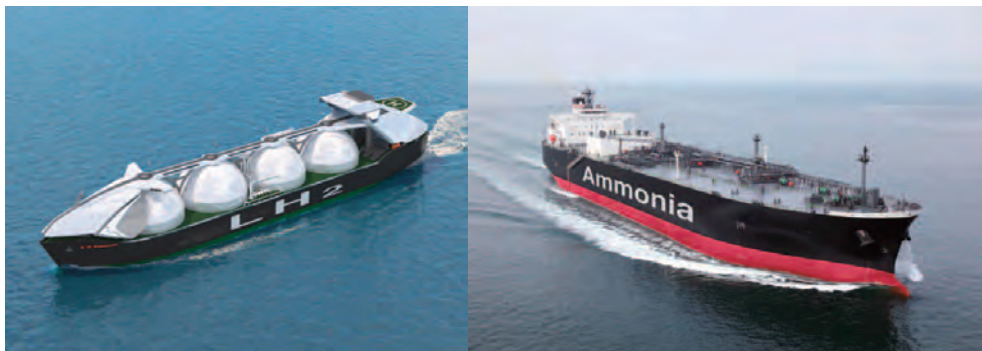
図1-3-3 大型液化水素運搬船（左）とアンモニア燃料アンモニア輸送船（右） （出典：川崎重工工業㈱（左）、日本郵船㈱（右））
