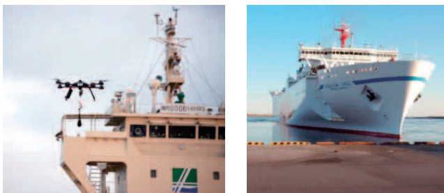
図4 「みかげ」の着栈時にヒービングラインを運ぶ無人ドローンと大洗港に自動着栈する「さんふらわあ しれとこ」
