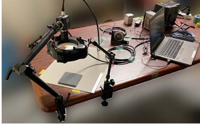
図 2.2 マルチスペクトルカメラによる計測の構成
