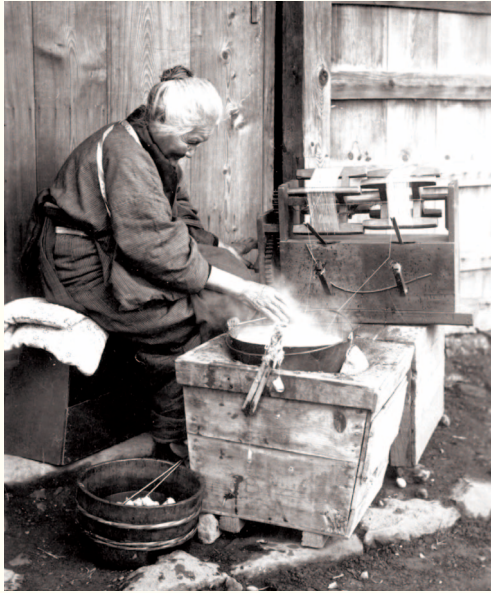
上州座繰器 1927(昭和2)年撮影 江戸末期から、上州(現在の群馬県地域)で使われていた家内製の製糸器械。湯を張った鍋に繭(まゆ)を入れ、そこから細い数本の繭糸(けんし)を手で取って、1本の生糸に紡いで歯車で巻き取っていく。 市立岡谷蚕糸博物館蔵
