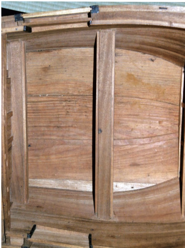
図 112 右近家八幡丸雛形の上面を閉ざした根棚
