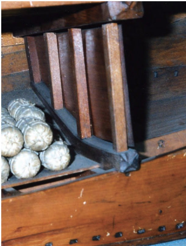
図 104 鉄道博物館雛形の中船梁兼用の三の間下船梁
