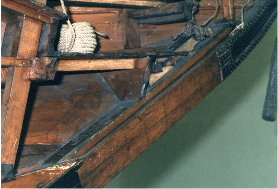
図 98 鉄道博物館雛形の内水押と外水押
