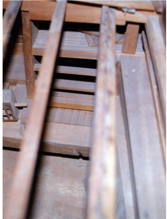
図 172 讃岐金刀比羅宮金比羅丸雛形の台間をふさぐ布板
