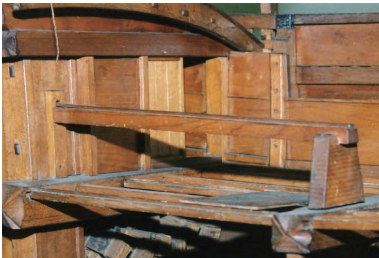
図 153 鉄道博物館雛形の胴の間の伝馬丑投入・丑投入受立・丑投入
