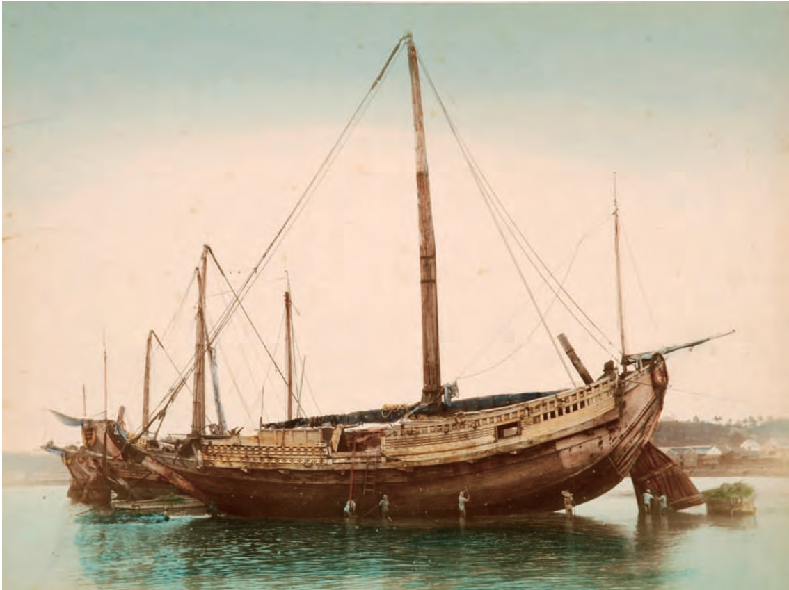
図 150 簡略版の二重垣立を装備した弁才船（横浜開港資料館蔵）
