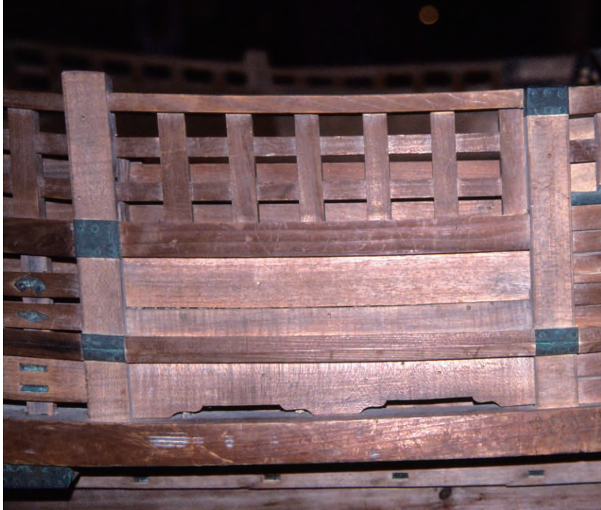
図 155 讃岐金刀比羅宮金比羅丸雛形の伝馬込
