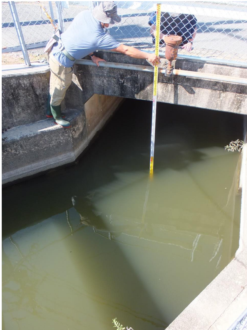
写真-7.1 町橋における水深の計測（2021年10月9日）
