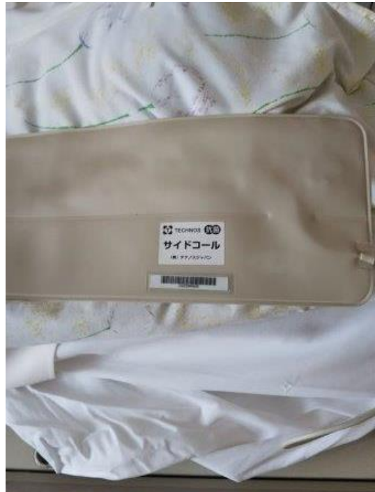
NS コール設備更新工事 (各種センサーマット類_コール連動)
