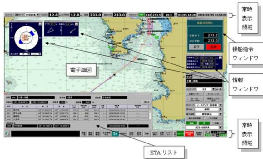
図 1.1.3 自動操船システムの概要
