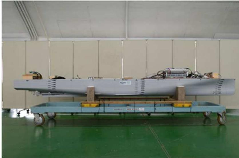
図 1.2.2 適用フェリーの水槽試験模型
