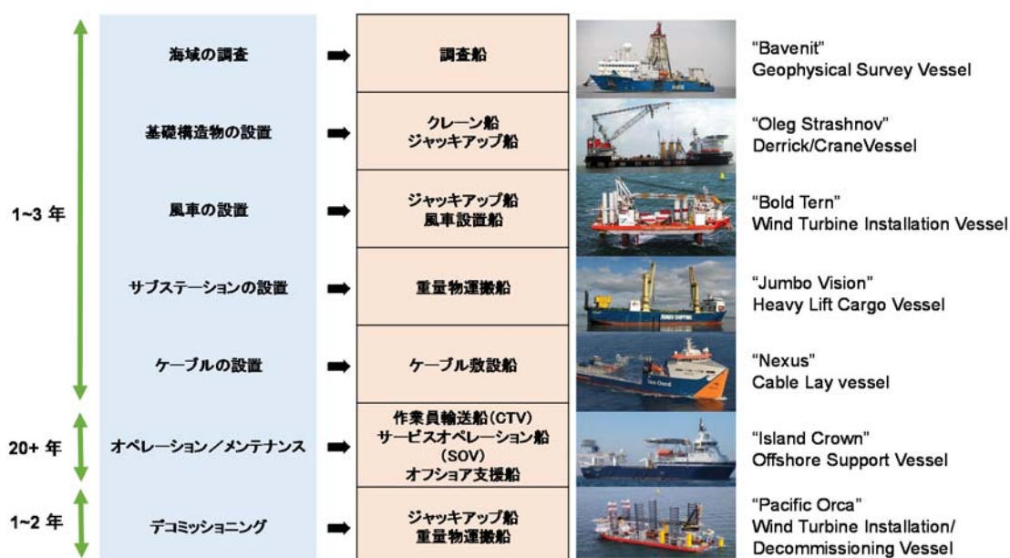
図 3.1 洋上風力発電設備の設置・運用に携わる船舶
