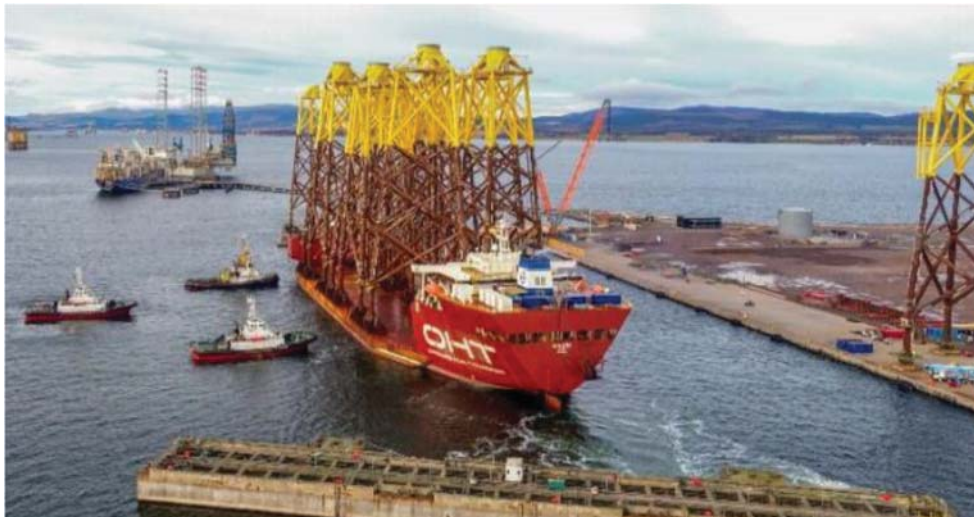
(写真) Lamprell で建造したジャケット構造物
