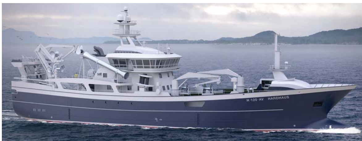
ハイブリッド型バッテリー駆動漁船「Hardhaus」（出典：Salt Ship Design）
