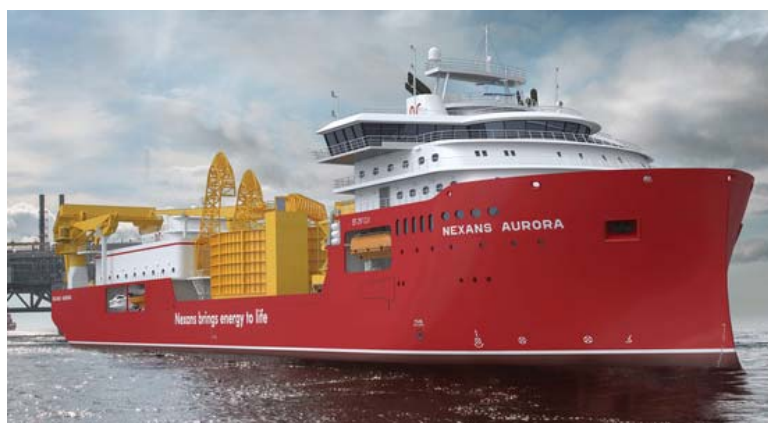
ケーブル敷設船「Nexans Aurora」(出典：Skipsteknisk)
