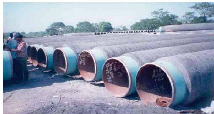
図 35：コンクリートを使った一重パイプ [66]
