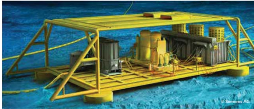
図 49 : サブシー電力システムの例
