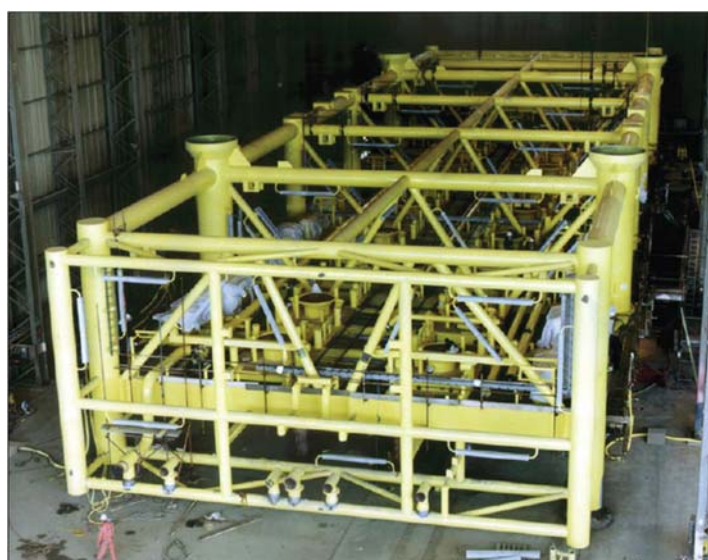
図 11 : テンプレートマニフォールド例 [5]
