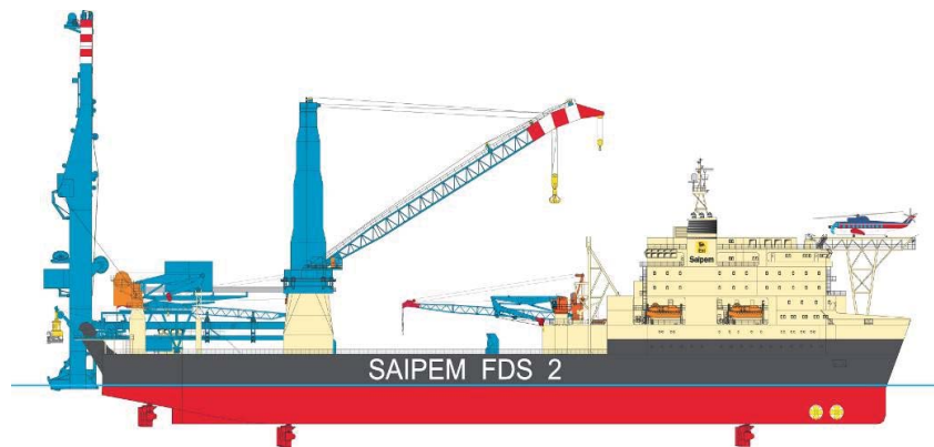
図 63：重量物起重機船の例
