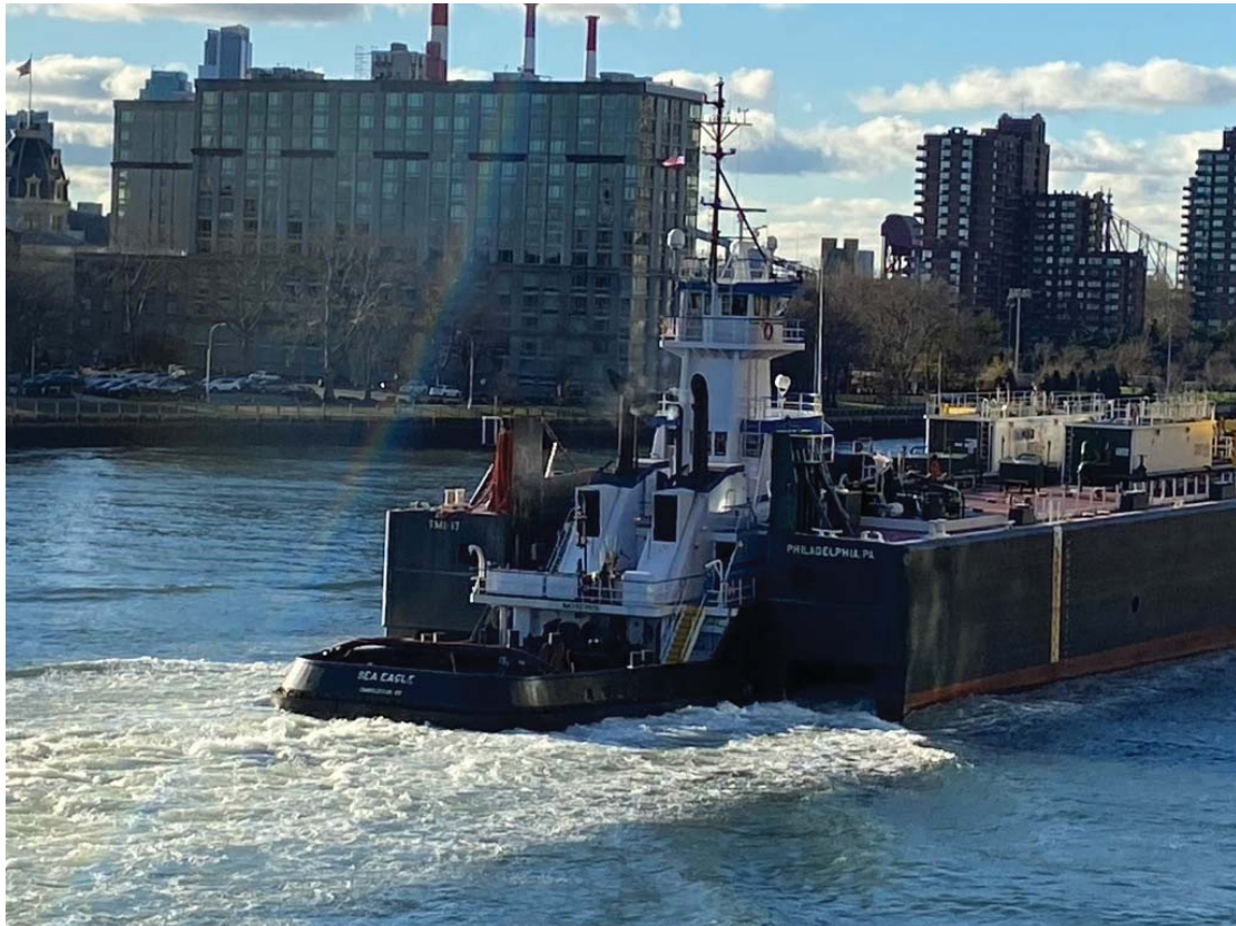
写真：ニューヨーク市のイーストリバーを航行中の ATB タグ Sea Eagle 1998 年建造 Kirby 所有、バージ TMI17 8,500 バレル 2020 年 12 月 6 日撮影
