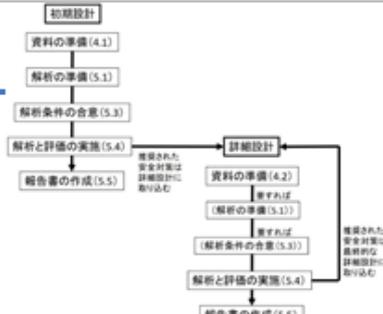
図1 自動運航船のリスク解析の手順
